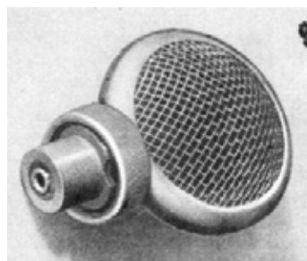
Die Kapsel des neuen Kristallmikrophons.
